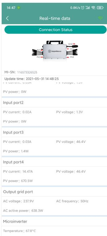
Nota: Si la señal del microinversor es tan débil que los datos en tiempo real no se actualizan, acerque la DTU al microinversor.
