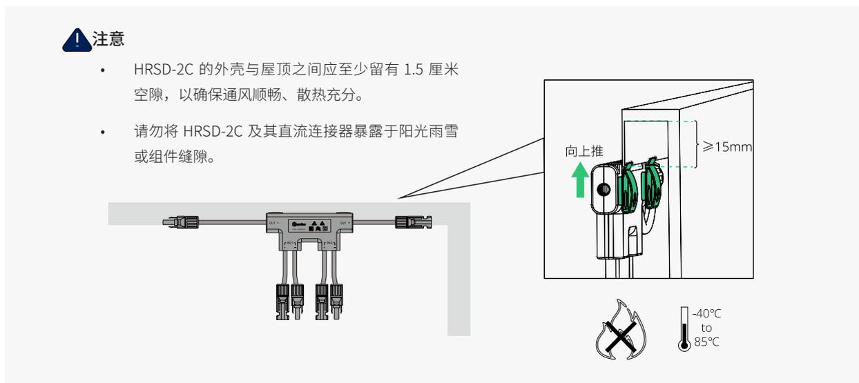
B) 将 HRSD-2C 的直流输入端子与光伏组件的直流输出端子对插。“咔哒”声响起证明端子插入到位。
