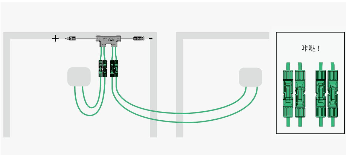
C) 将两台相邻 HRSD-2C 的直流输出端子对插。“咔哒”声响起证明端子插入到位。
